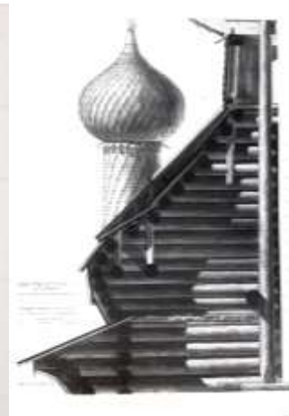
Обмер церкви и конструкция куба выполненный А.В. Ополовниковым
